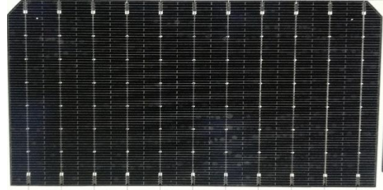
Toplama(Busbar) ve ızgara (Fingerprint) hatları (Busbars and Fingerprints of PV Module)
